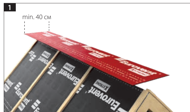
Инструкция по монтажу коньковой ленты Eurovent®
