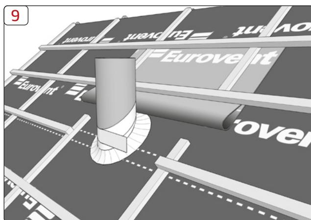
**Další doporučení:** Všetky perforácie, poškodenia a roztrhnutia membrány musia byť opravené pomocou pásky Eurovent® TOPBAND alebo Eurovent® UNO COLD UV.
