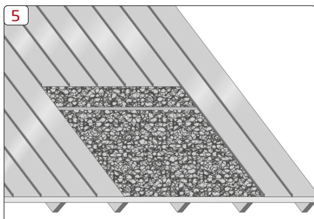
Visokoparopropusna krovna membrana namijenjena je za primjenu kao dodatni izolacijski sloj za kose krovove. Proizvod zahtijeva punu oplatu. Završni odabir krovne membrane određuje projektant.
