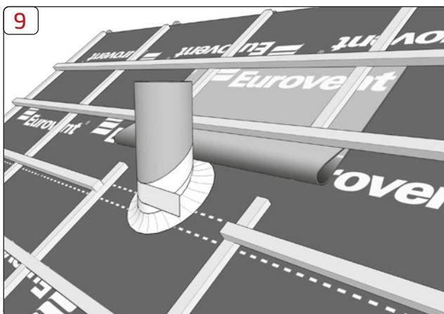
**Dodatne preporuke:** Svi proboji, oštećenja i pukotine na membrani moraju se bezuvjetno popraviti korištenjem Eurovent® TOPBAND ili Eurovent® UNO COLD UV trake.
