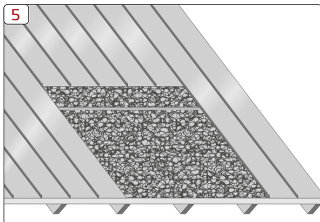
L'écran sous-toiture hautement perméable à la vapeur est destiné à être utilisé comme couche isolante supplémentaire pour les toitures inclinées. Ce produit requiert un voligeage continu. Le choix final de l'écran sous-toiture relève du concepteur.
