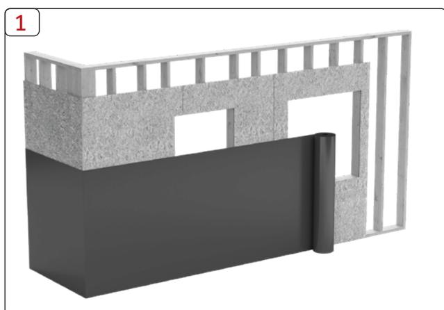
**2:** Fixez les couches suivantes de la membrane, en veillant à ce que le chevauchement sur la couche inférieure soit d'au moins 15 cm, en couvrant les ouvertures des fenêtres et des portes.
