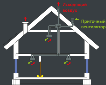
МЕХАНИЧЕСКАЯ ВЕНТИЛЯЦИЯ - РЕКУПЕРАТОР
