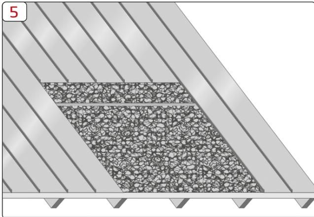
Die hochdampfdurchlässige Dachbahn ist als zusätzliche Dämmschicht für geneigte Dächer bestimmt. Das Produkt erfordert eine vollflächige Schalung. Die endgültige Auswahl der Dachbahn trifft der Planer.
