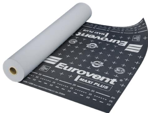
3-lagige diffusionsoffene Unterdeckbahn. Hergestellt aus zwei Schichten von Polypropylenvlies und aus einem Funktionsfilm, der hochdiffusionsoffen und wasserdicht ist. Hohe Reißfestigkeit gewährleistet dem Dachdecker leichte Verarbeitung. Das Produkt enthält spezielle Stabilisierungsadditive, die die Montage der Dachdeckung mit einem Zeitverzug ermöglicht. Die Ausführung erfolgt auf Wunsch in einer Variante mit zwei Klebebändern (SK2-Bezeichnung).
